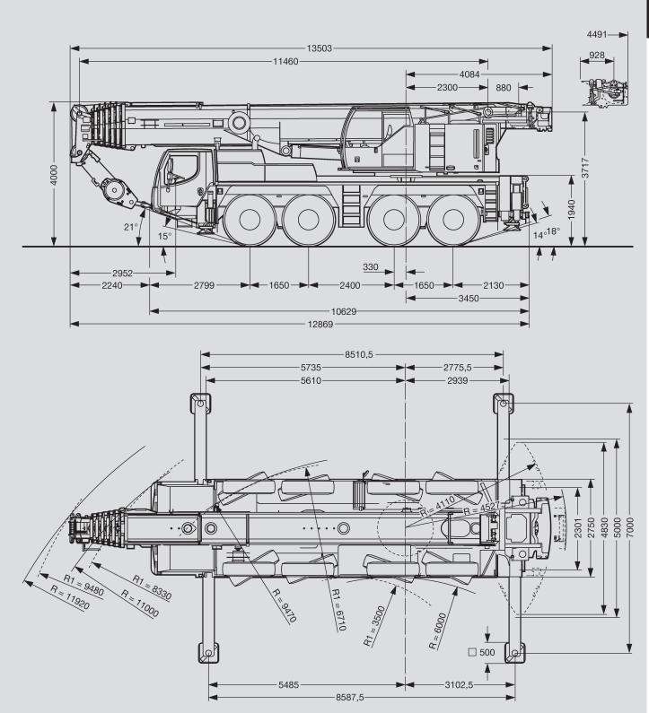
R<sub>1</sub> = Allradlenkung · All-wheel steering · Direction toutes roues · Tutti gli assi sterzanti · Dirección en todos los ejes · Поворот всеми колесами
