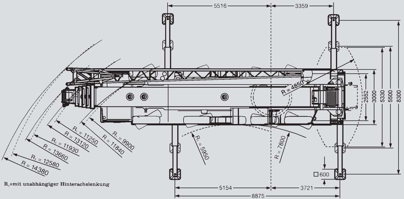
R<sub>1</sub>=mit unabhängiger Hinterachslenkung
